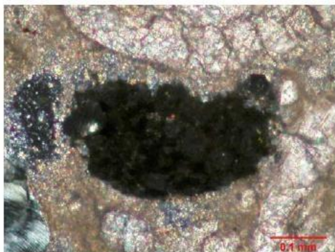
Campione M1: dettaglio di un granulo non idratato di cemento (luce trasmessa, N+ a sinistra, N// a destra).
